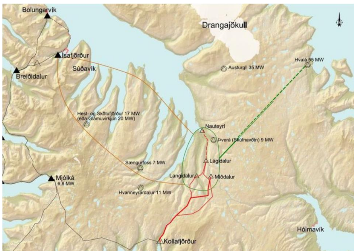
Mynd 12. Mögulegar tengingar Hvalárvirkjunar og Austurgilsvirkjunar við flutningskerfið frá árinu 2020 (Heimild: Kjarninn/Landsnet).
